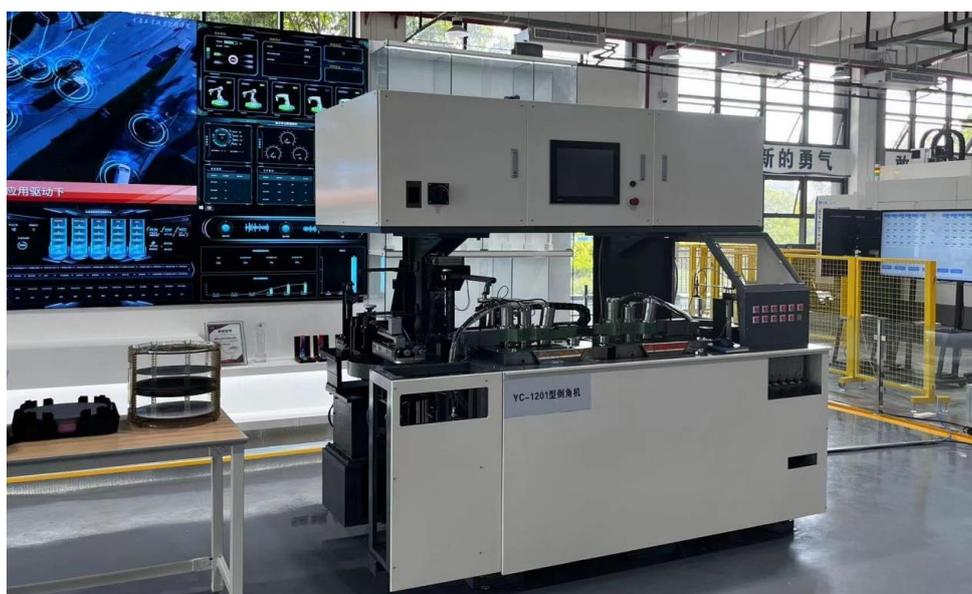
图 32：倒角机设备完成现场图
